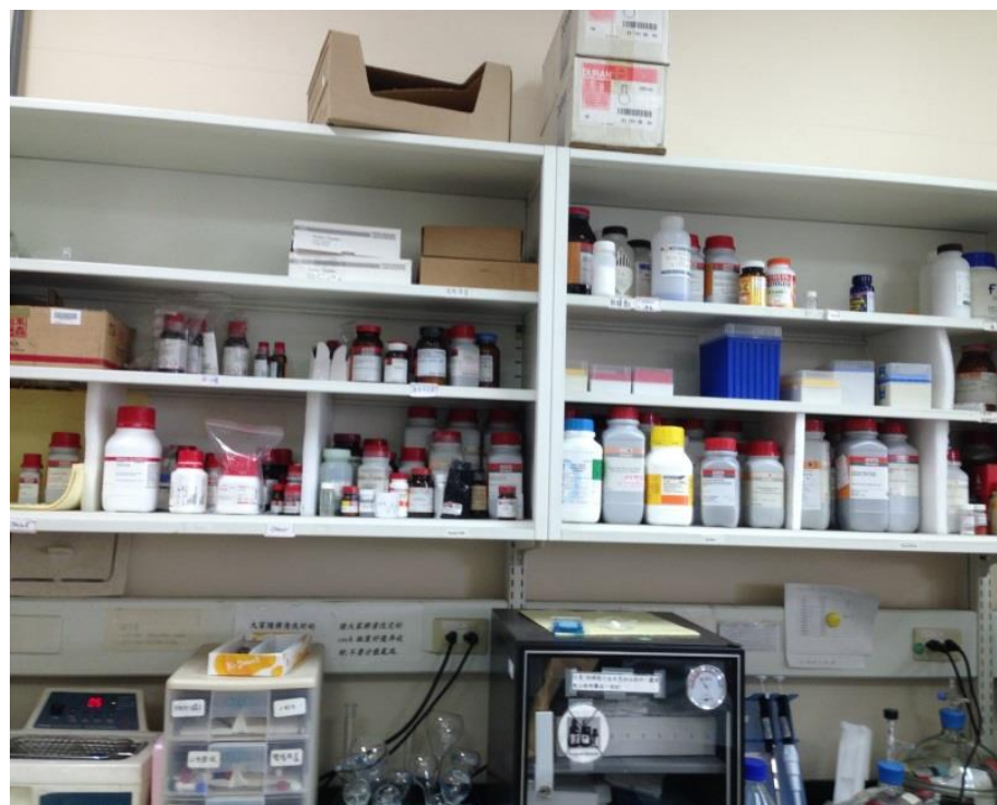
藥品櫃請增設檔板，以防地震引起之危害
