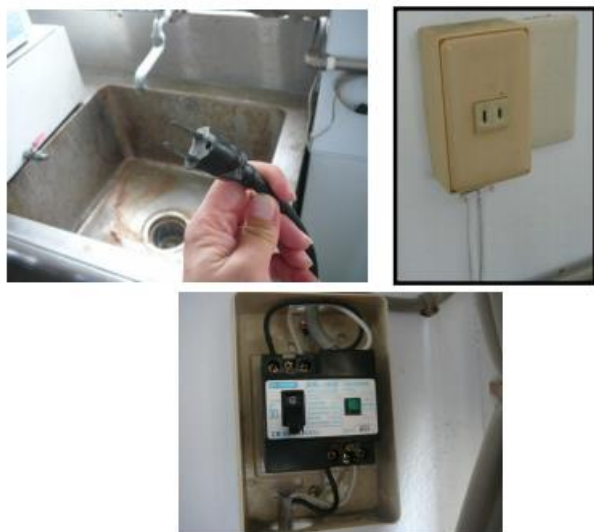
水浴槽放在不銹鋼水槽上插電，以三用電表量測水浴槽及不銹鋼水槽間有116.8V 電壓差
