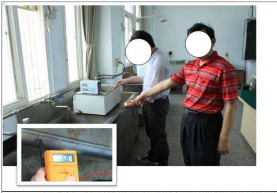
水浴槽放在不銹鋼水槽上插電，以三用電表量測水浴槽及不銹鋼水槽間有116.8V 電壓差
