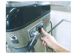
6. 按下紅色電源鍵啟動攪拌機。如要變換轉速，必須先按下紅色電源鍵停止攪拌，再調整成其他轉速，避免在運轉時調整轉速。
