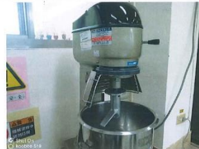
1. 確認電源於關閉狀態下將攪拌架置入攪拌缸中，拿置固定位置確實扣緊
