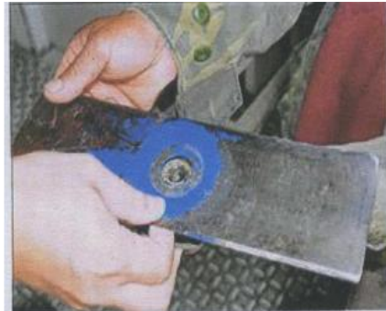
傷人致死的斷裂刀片，裂紋清晰可見。（記者甘育瑋攝）
